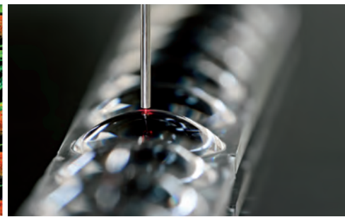
50-µm-Sonde im Größenvergleich (Bild links). Messungen in einer 200-µm-Bohrung einer Multilayerplatine und hochauflösender 3-D-Scan der Platinenoberfläche (Bilder Mitte). Oberflächenscans auf einem Linsenarray (Bild rechts).
